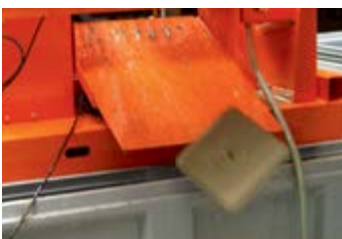
Filterkuchen fallen in Sammelbehälter
